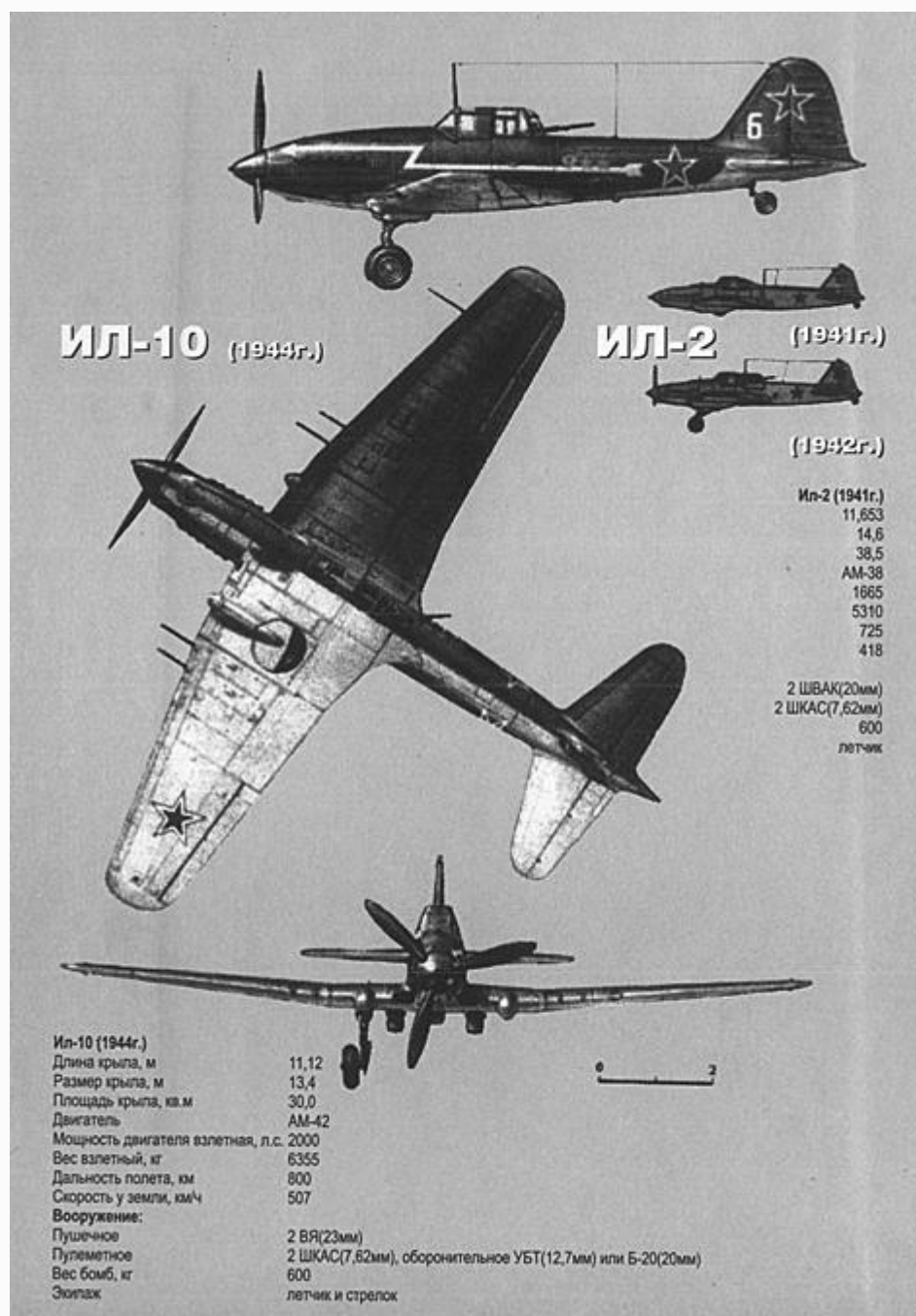
Ил-10 образца 1944г. и Ил-2 образца 1941 г. и 1942 г. (характеристики и вооружение)
